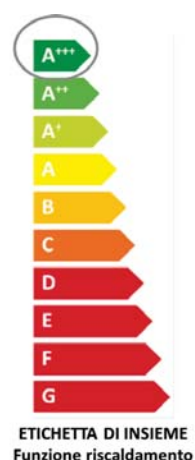
Fig. 9 – Scala di efficienza: etichetta di insieme: combinazione di apparecchiature di riscaldamento d'ambiente.
